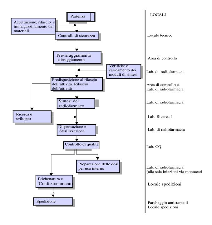
Fig.2 Diagramma di flusso del processo produttivo dei radiofarmaci e della localizzazione di ogni singola fase del processo
