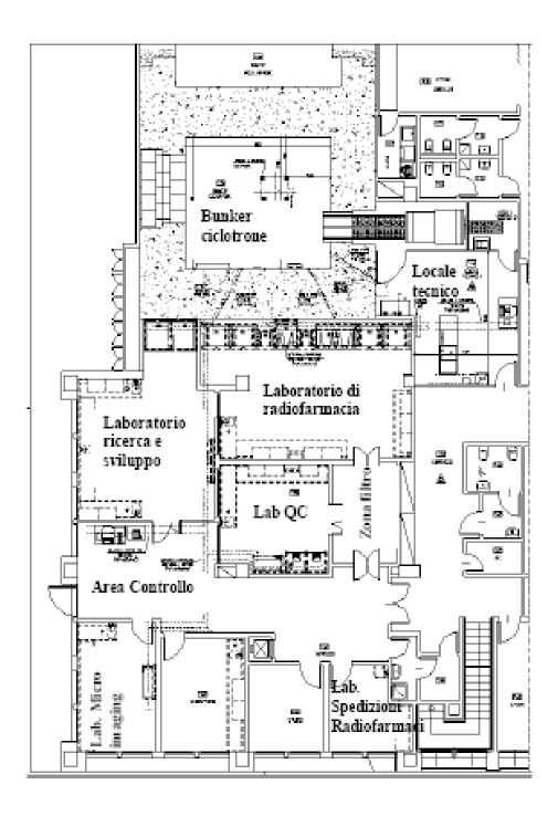
Fig.1 Planimetria della Radiofarmacia PET
